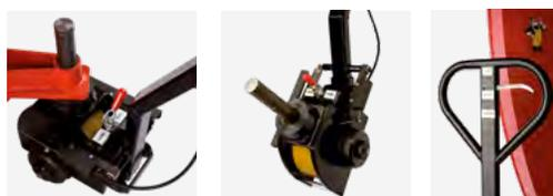
Manuelle, assistée par le **positionneur mécanique Hydrobull, FaPo en abrégé®**. L'appareil entier, **avec** ou sans charge, se laisse manœuvrer et conduire sans peine par une seule personne. Le timon offre un angle de braquage de presque 180 degrés, permettant quasiment de faire pivoter l'appareil autour des roues avant avec un rayon de rotation réduit.
