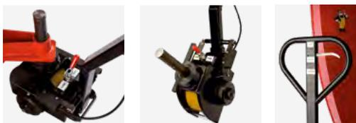
Manuelle, assistée par le **positionneur mécanique Hydrobull, FaPo en abrégé®**. L'appareil entier, avec ou sans charge, peut être manœuvré et conduit sans peine par une seule personne. Le timon offre un angle de braquage de presque 180 degrés, permettant quasiment de faire pivoter l'appareil autour des roues avant avec un rayon de rotation réduit.
